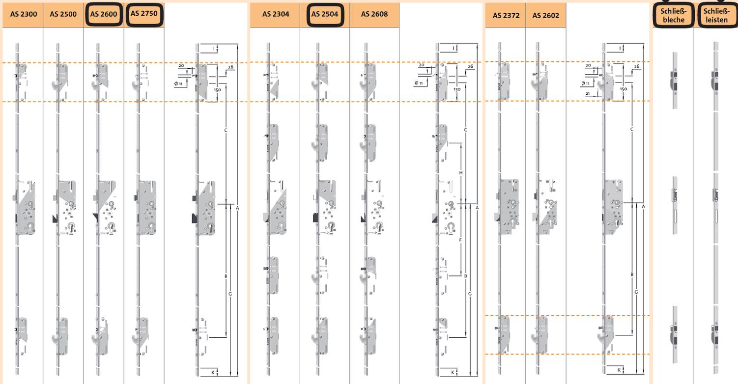
Die Mehrfachverriegelungen der neuen Generation zeichnen sich durch ihre Einheitsmaße aus. Sowohl die Abstände zwischen Haupt- und Nebenschlosskästen als auch deren Abmessungen sind bei allen Ausführungen identisch.
