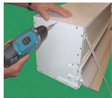
Blenden mit Kopfstücken verschrauben
