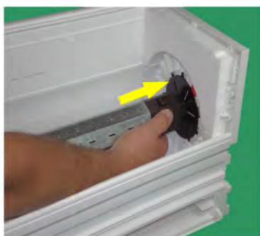
Walzenkapsel in Lagerscheibe teleskopieren
