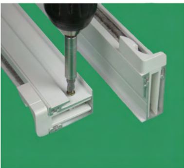
Riegel in U-Profile einsetzen und verschrauben
