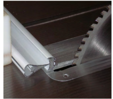
Zugschiene Tür zuschneiden
