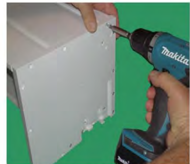
Kopfstück mit Blenden verschrauben
