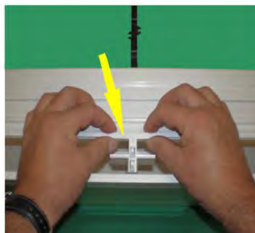
Doppelkopfstück in RK einsetzen und an Vorder- und Hinterkante mit Basisbrett verrasten
