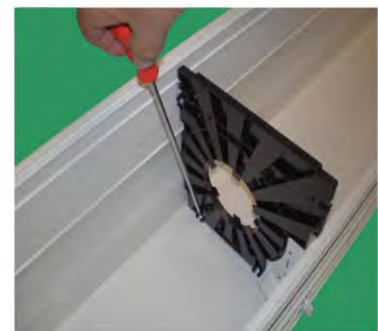
Doppelkopfstück beidseitig im RK verschrauben (3,9 X 9,5)
