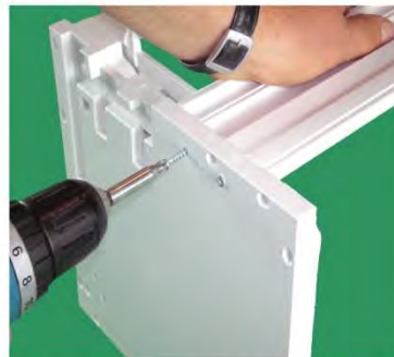
Basisbrett mit Kopfstück verschrauben
