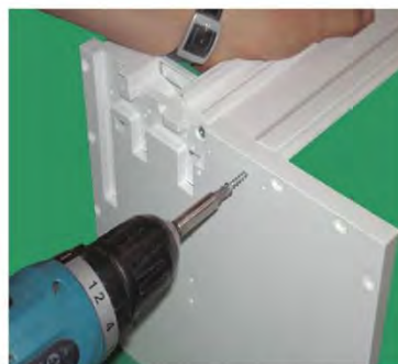
Kopfstücke mit Basisbrett verschrauben
