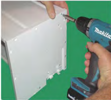
Kopfstücke mit Blenden verschrauben
