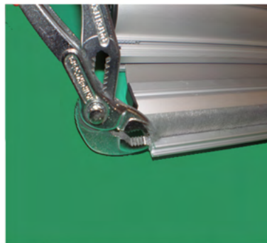
Bürstendichtung seitlich in Zugschiene festklemmen
