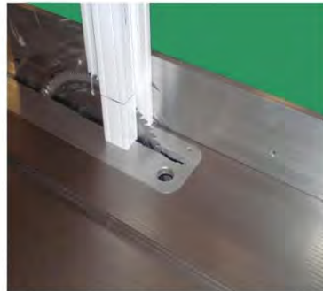
Ausklinken eines Adapters 60 mm von Oberkante und 26 mm von Vorderkante. Achtung: Reststück wird noch benötigt!
