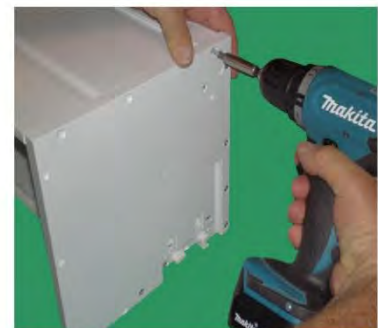
Kopfstücke mit Blenden verschrauben
