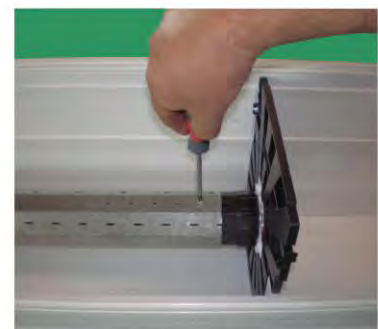
Walzenkapsel mit Schraube sichern
