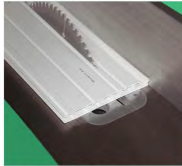
Reviblende aus Bausatz auf Breite schneiden
