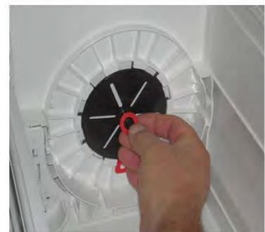
Distanzring für Mini-Gurtscheibe auf Lagerzapfen schieben
