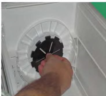
Lagerscheiben in Kopfstück einsetzen und drehen
