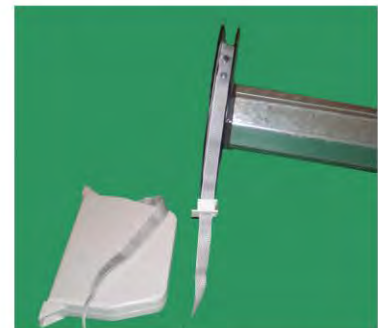
Gurt mit Gurtdurchführung an Gurtscheibe befestigen
