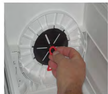
Distanzring für Mini-Gurtscheibe auf Lagerzapfen schieben
