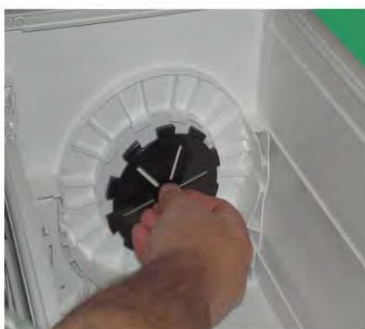
Lagerscheiben in Kopfstücke einsetzen und drehen
