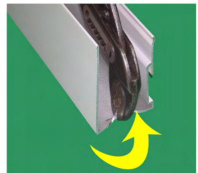
Adapter mit Zange an Markierung umbördeln
