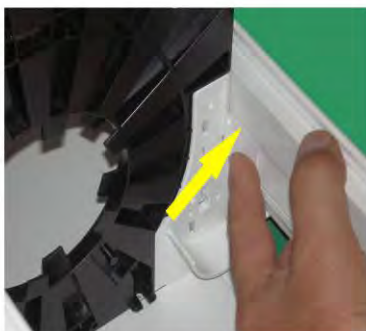
Doppelkopfstück in RK einsetzen und an Vorder- und Hinterkante mit Basisbrett verrasten
