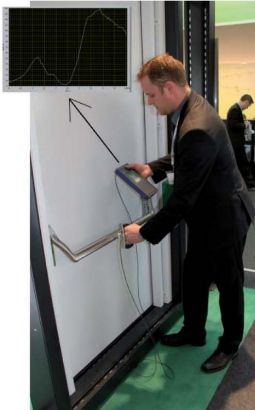
Rysunek 5 Pomiar sił zwolnienia Źródło zdjęć: © ift Rosenheim MessTec Technika kontrolna i pomiarowa
