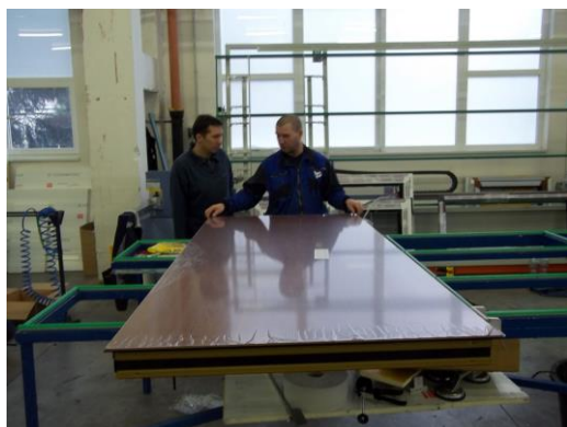
1. Próbna instalacja wypełnienia w ramie skrzydła i sprawdzenie wzajemnego pasowania
