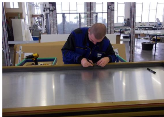
2. Zmierzenie i zaznaczenie pozycji otworów (przeznaczonych do przymocowania wypełnienia) wokół obwodu ramy skrzydła drzwi. Otwory należy umieścić przeciw uchwytom po bokach wypełnienia drzwiowego.
