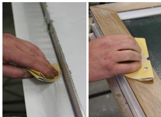
4. Zszorstkowanie powierzchni nakładki wypełnienia drzwiowego i powierzchni ramy skrzydła drzwi, tj. powierzchni klejonych.
